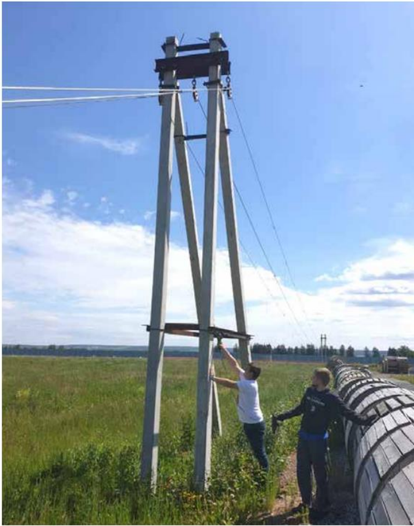
Рис. 3 Испытание системы DAS на чувствительность к попытке выпиливания элементов опоры.
