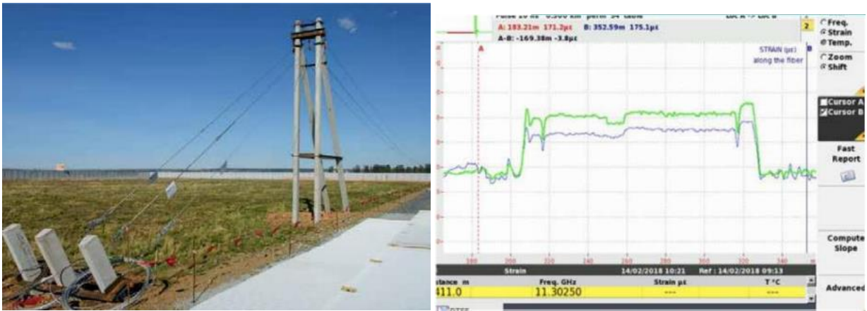
Рис. 7 Общий вид уличного станда и график измеренного удлинения оптического волокна до имитации воздействия гололеда и после.
