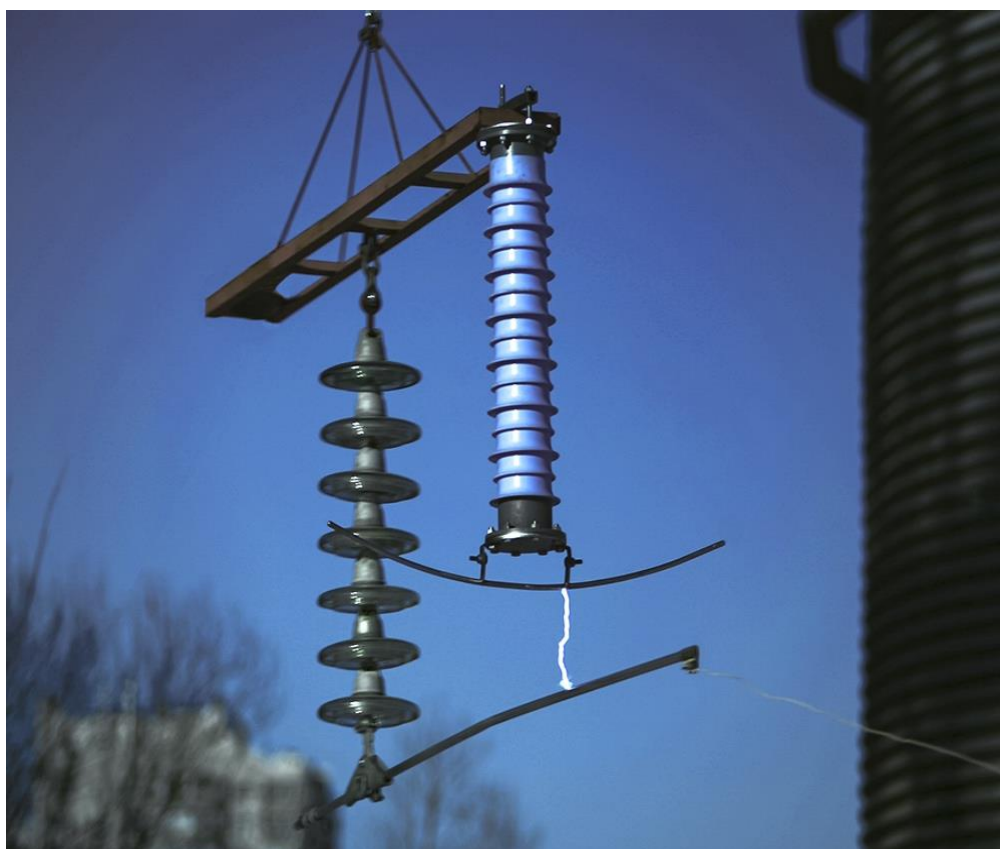
Рисунок 6 – Проверка возможности защиты изоляторов от перекрытий.
