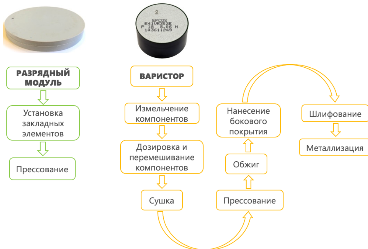
Рисунок 4 – Сравнение технологии изготовления РМ и варисторов.
