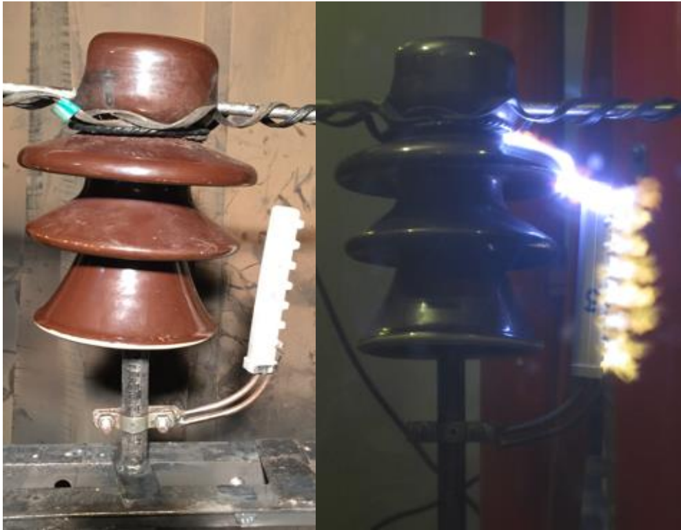
Рис. 4. Разрядник РМКИ10, установленный на штырь изолятора ШФ10Г:
